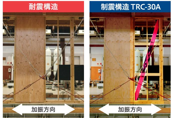
※右の画像は、TRCダンパーを取り付けた部分が見えるよう、ピンクで塗りつぶしています。
