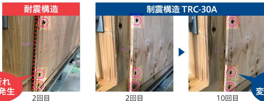
TRCダンパーを設置した制震構造は10回目の地震後も合板が健全な状態である事が確認できました。
