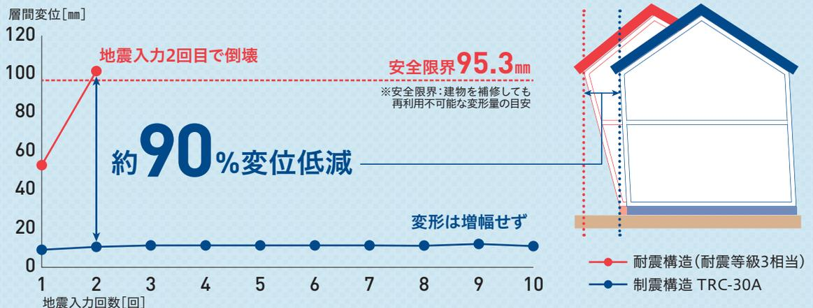
TRCダンパーを設置した制震構造は、熊本地震相当波で10回揺らしてもほとんど変形せず、「繰り返しの地震」に強いことを実証しました。
